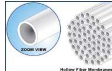
Ultrafiltration: Hohlfasern aus Kunststoff (Polyethersulfon oder PVDF) geeignet bei einem Ganzjahresbetrieb
